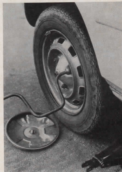
Con la rueda en el suelo, mediante la manivela aflojaremos las tuercas que sujetan la rueda
