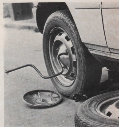
Una vez aflojadas las tuercas de la rueda, colocamos el gato en el punto base de nuestro vehículo más cercano a la rueda pinchada. Este punto base lo suele indicar el libro manual de nuestro vehículo
