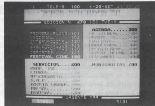
Teletexto Europeo con decodificador de nivel 1 (96 caracteres) observe abajo, a la izquierda sólo hay 1 color en la banda.
