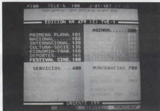
Teletexto Español con decodificador de nivel 1.5 (128 caracteres) la banda de abajo tiene cuatro colores rojo, verde, amarillo y azul.
